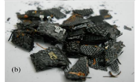
Fotos von PCB-Schrott (a) verbrannt (b) pyrolysiert bei 600°C nach 50 Minuten
