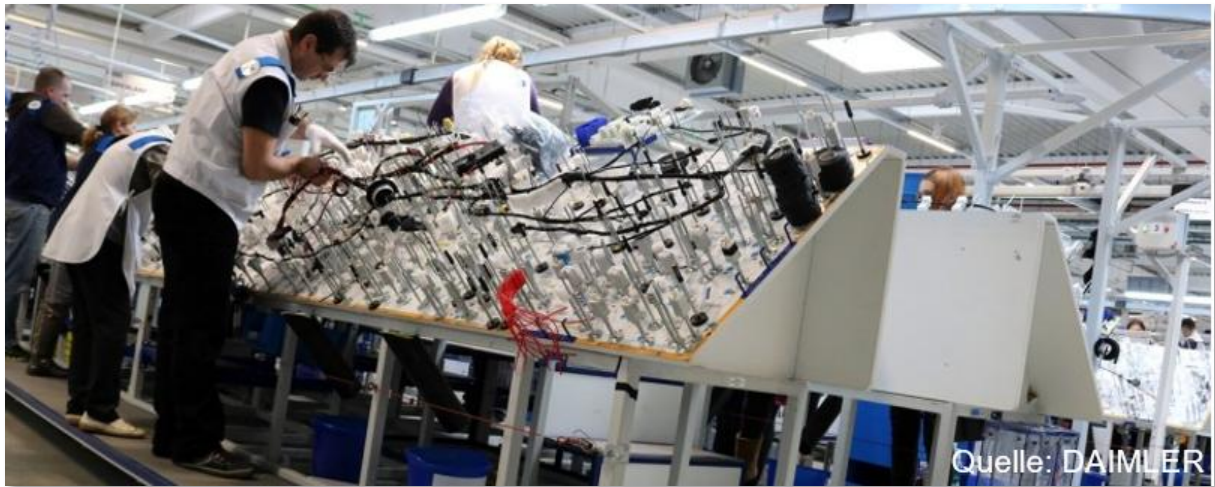
Abbildung 2: Manuelle Endmontage von Leitungssätzen an Formbrettern
