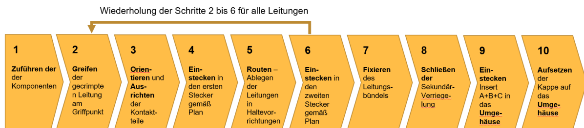
Abbildung 14: Prozesskette zur Montage des Leitungssatzes
