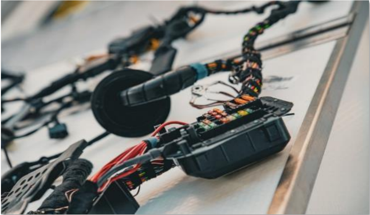
Abbildung 1: Beispielhafter Leitungssatz mit integrierter Sicherungsdose
