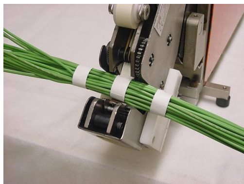
Abbildung 12: Spot taping Maschine zum Setzen von einzelnen Klebebändern (Quelle https://www.springmillsmf.com/ )
