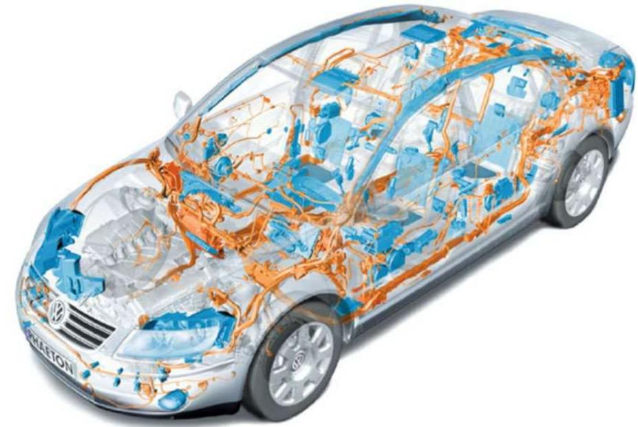
Bordnetz (orange) und Elektronikkomponenten (blau) eines Oberklasse-Fahrzeugs [1]
