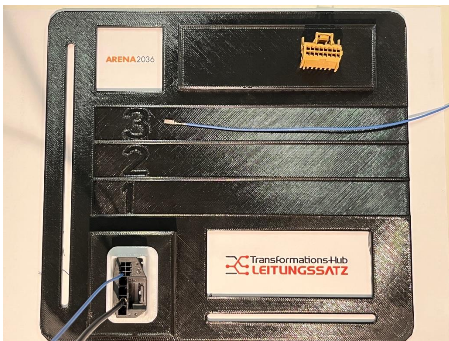
Abbildung 15: Task 3 Schritt 2; Lagerichtiges Zuführen und Einstecken des MQS-Kontaktes in das Buchsengehäuse Kammer 5
