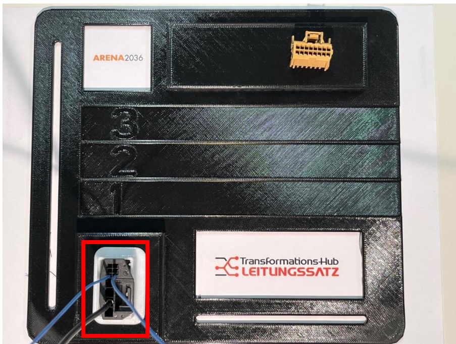
Abbildung 17: Task 3 Schritt 5; Lagerichtiges Zuführen und Einstecken des MQS-Kontaktes in das Buchsengehäuse Kammer 8
