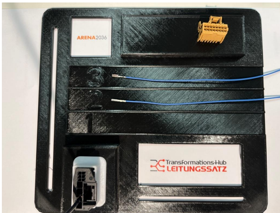
Abbildung 13: Task 2 Schritt 2; Lagerichtiges Zuführen und Einstecken des AMP MCP2.8K Kontaktes in das Buchsengehäuse Kammer 2
